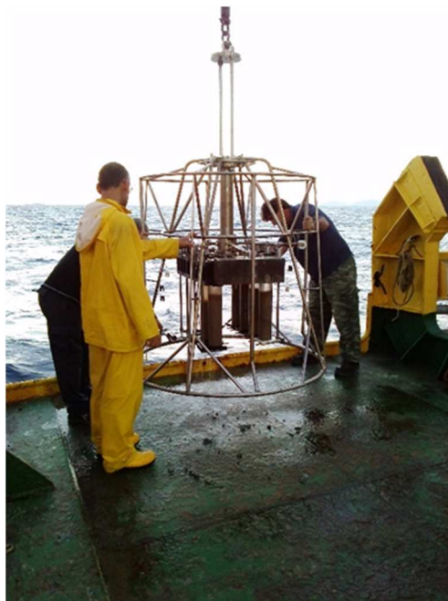
Εικόνα 3.1: Δειγματοληψία με χρήση πολυπυρηνοδειγματολήπτη
