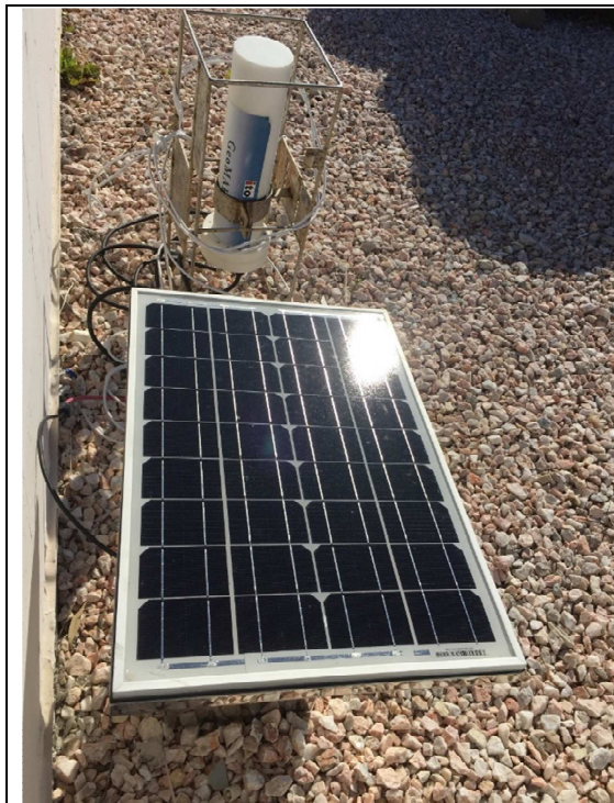
Σχήμα 1. Το σύστημα επικοινωνίας μαζί με τον ανιχνευτή GeoMAREA. Το σύστημα επικοινωνίας αποτελείται από το δρομολογητή (router), τον επαναφορτιζόμενο συσσωρευτή, τη φωτοβολταϊκή μονάδα και το ρυθμιστή φόρτισης.
