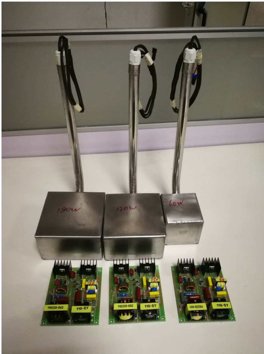
Εικόνα 5. Τρεις από τους πρωτότυπους transducers που ανέπτυξε η Citadel Products Ltd στα πλαίσια του συγκεκριμένου προγράμματος. Η φωτογραφία αυτή μας δόθηκε από την εταιρεία.
